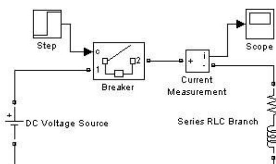
Параметры расчета: Simulation time (Start time – 0, Stop time – 0.1); Solver options (Type – Variable-step, Solver – ode23tb); остальные параметры – по умолчанию.
